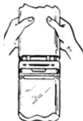
Appuyer sur un côté du tuyau jusqu'à ce que le joint s'enclenche.
