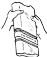
Appuyer sur l'autre côté du tuyau jusqu'à ce que le joint soit engagé.
